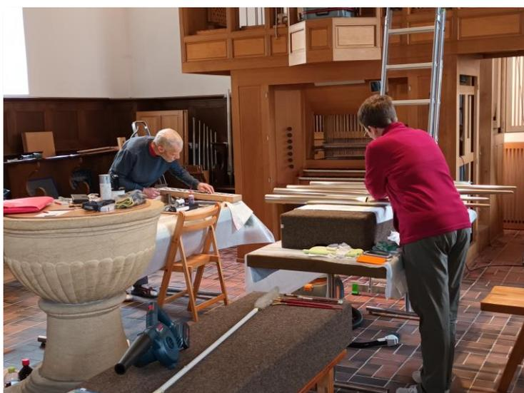
Zwei Mitarbeitende der Orgelbaufirma F. & L. Ayer, Orgelbau in Vauderens, welche seit Jahren die regelmässigen Wartungsarbeiten sorgfältig ausführt, befreien die Orgel vom Staub. Sie reinigen die Pfeifen, ersetzen defekte Teile und optimieren das Werk, nachdem die letzte Revision ein Vierteljahrhundert zurückliegt.
